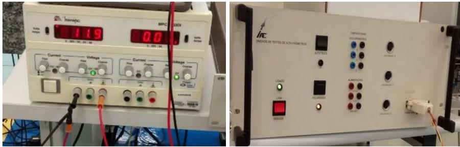
Figura 7. Fontes de alimentação do disco térmico, do Crio e do sensor inercial.
