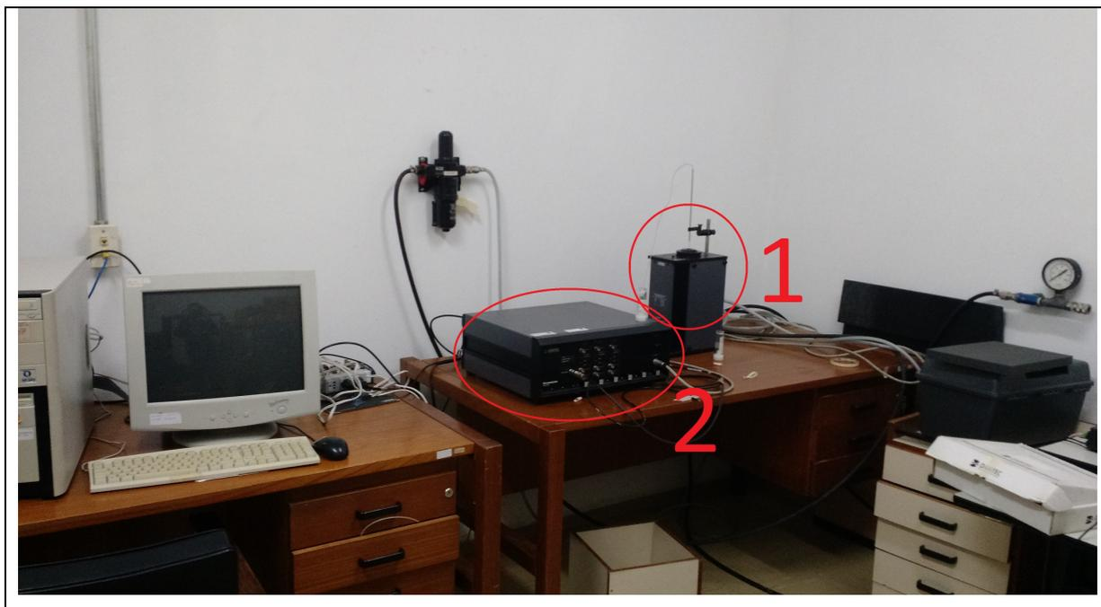
Figura 3. Sistema de calibração de fio quente.
