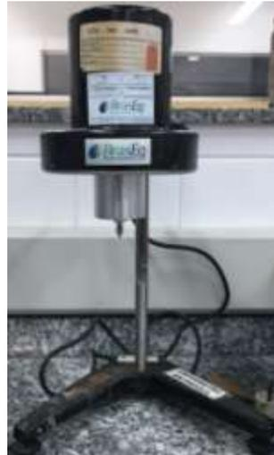
Figura 2 – Equipamento viscosímetro analógico da marca Brookfield, modelo LV.
