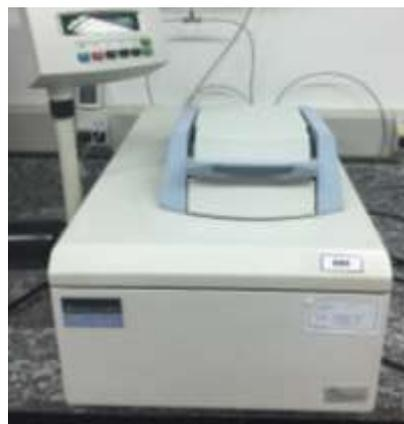
Figura 3 – Equipamento de Calorimetria Exploratória Diferencial (DSC) Perkin Elmer modelo Pyris 1.
