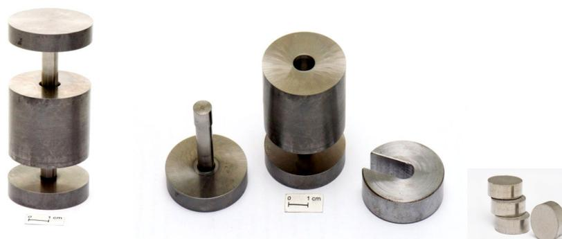
Fig. 5. Matriz cilíndrica Ø 10 mm em aço VC 131 e amostras compactadas.
