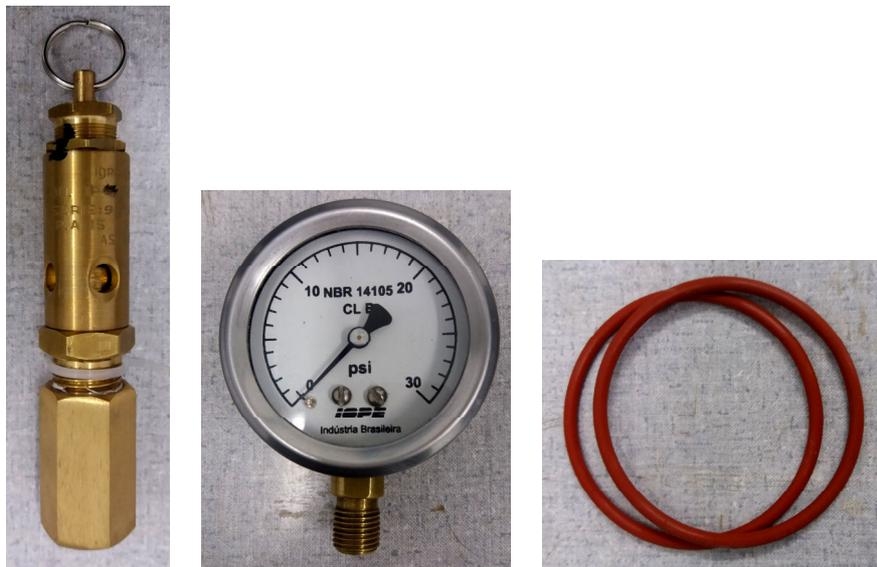
Fig. 2. Válvula de segurança (15 psi), manômetro (30 psi) e o-rings de silicone adquiridos para montagem do forno de hidrogenação.
