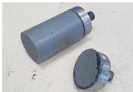
Figura 4. Corpo de prova após romper no ensaio de adesão.
