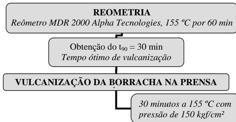
Figura 1. Fluxograma da preparação da proteção térmica.
